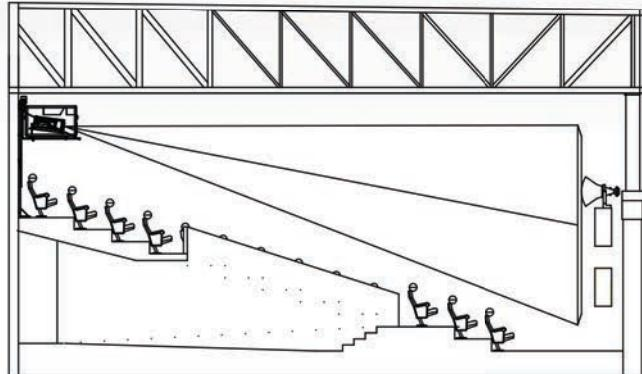
**El elevador de pared P-WALLIFTBOX permite descender nuestra solución para cine sin cabina, el P-SBOX15, desde su ubicación de proyección en la parte alta de la pared de fondo de sala hasta la posición de mantenimiento.**
